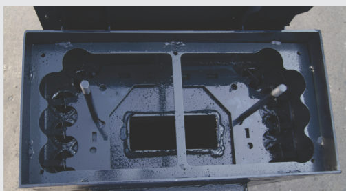
cevni izmenjivač sa mehanizmom za čišćenje
